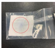
繊維製品への特定タンパク質の滴下及び反応
